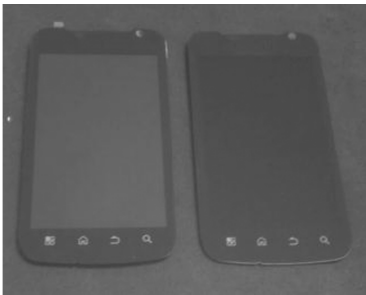
图 3 一般触控显示模组(左)与全贴合触控显示模组(右)对环境光反射的对比
